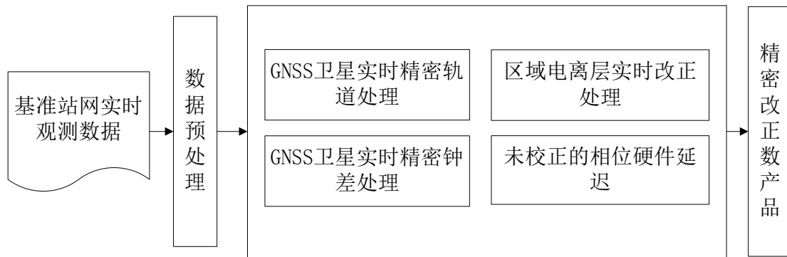
图 1 广域实时精密定位处理流程
